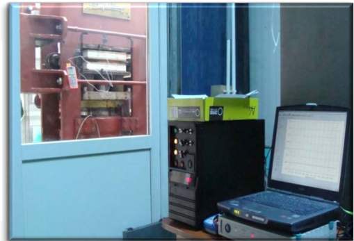
EN 1337-3: 2005 Aparate de reazem pentru structuri Determinarea unor caracteristici de compresiune și forfecare : -Modulul de forfecare (-20° C)
