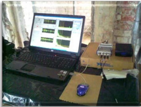
Monitorizarea vibrațiilor structurale într-o clădire de patrimoniu (Hotel Cișmigiu, București)
